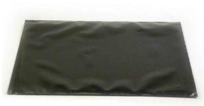
Deska na výrobu plošných spojů fotochemickou cestou
