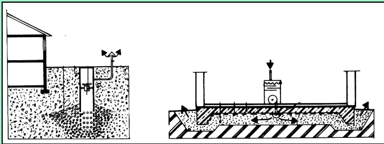
**Měření rozpadových produktů radonu pomocí LLM 500**
