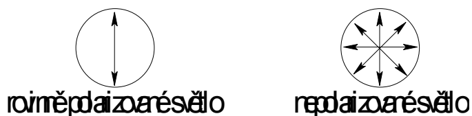
Obrázek: Schéma rovinně polarizovaného a nepolarizovaného světla (oboustranné šipky vyznačují příklady rovin, v nichž mohou paprsky kmitat).
