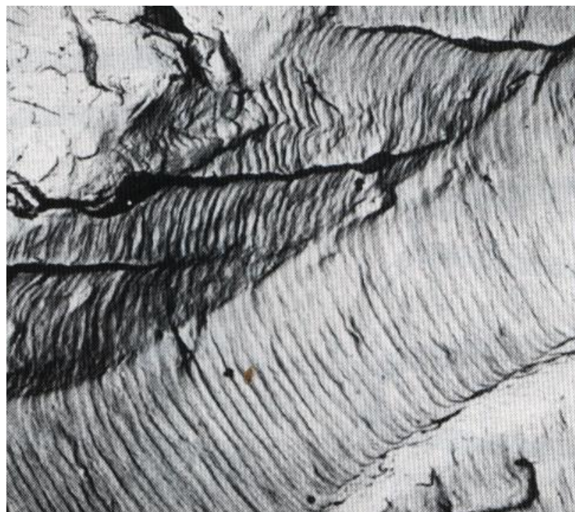
Obr.12.13. Mikrofotografie lomu hliníku (s charakteristickým žlábkováním) [ 2 ].
