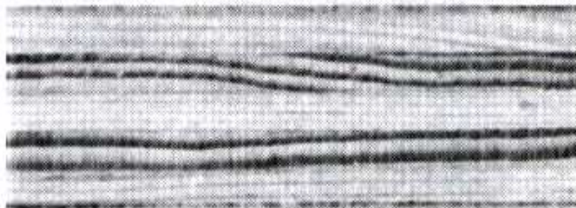
Obr.10.23. Jeden z nejznámějších laminárních kompozitů – dřevěná překližka.
