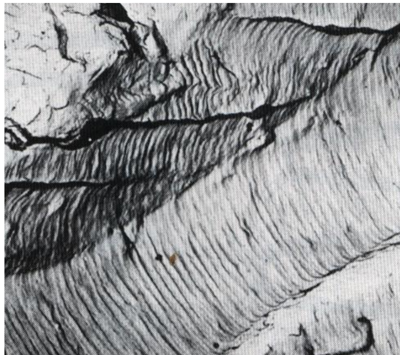
Obr.12.13. Mikrofotografie lomu hliníku (s charakteristickým žlábkováním) [ 2 ].
