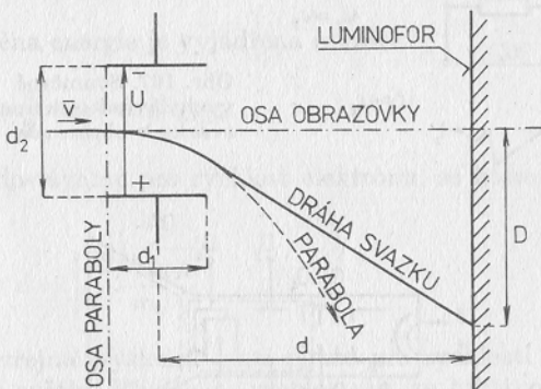
Obr. 169. Výchylka svazku při vychylování elektrostatickým polem
