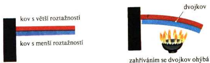
Obr. 4.13. Bimetal jako spínací prvek.
