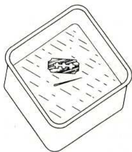
Obr.9.6. Drobné kovové předměty „plavou“ na povrchu kapaliny díky povrchovému napětí.
