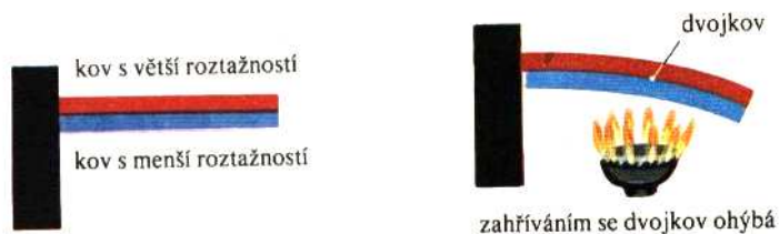
Obr. 4.13. Bimetal jako spínací prvek.
