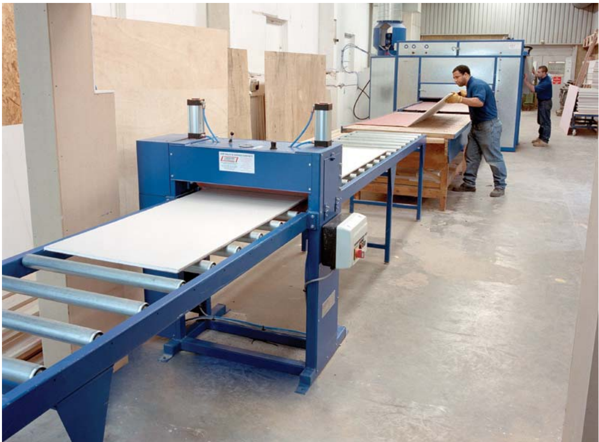
Obr. 6.2: Průběžná radiační kontrola tloušťky a kvality ochranných panelů
