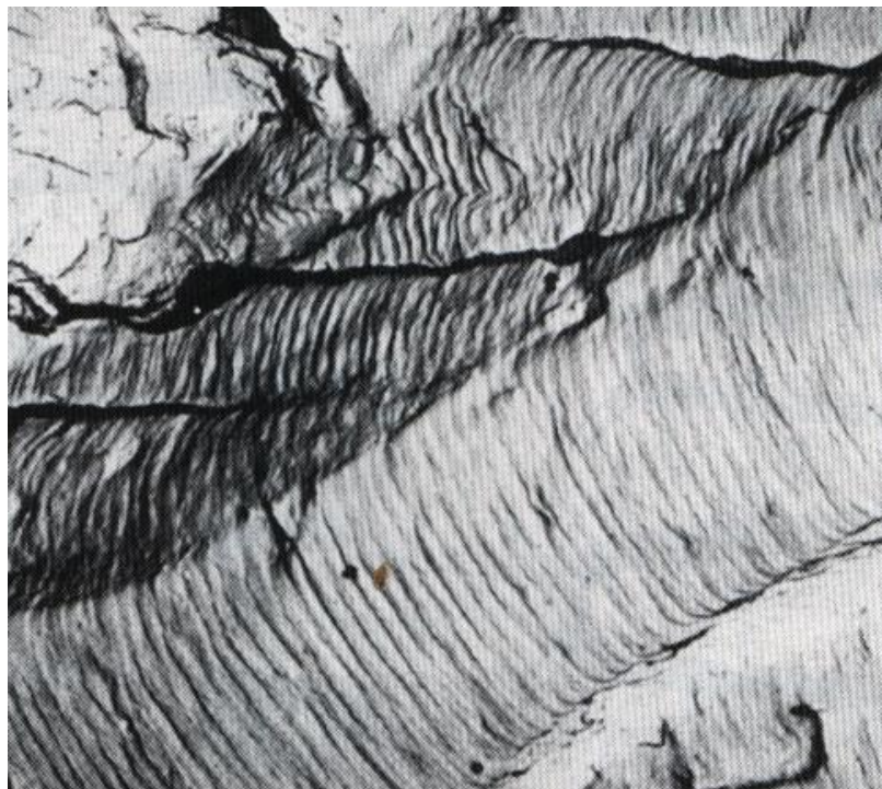
Obr.12.13. Mikrofotografie lomu hliníku (s charakteristickým žlábkováním) [ 2 ].
