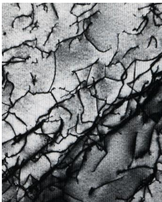
Obr.4.8. Elektronová transmisní mikrofotografie (titan).
