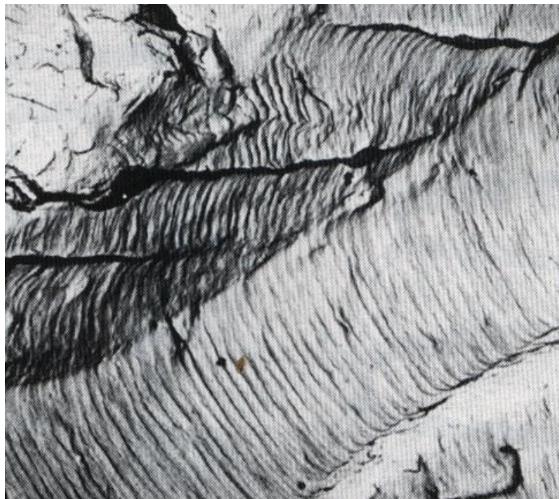
Obr.12.13. Mikrofotografie lomu hliníku (s charakteristickým žlábkováním) [ 2 ].
