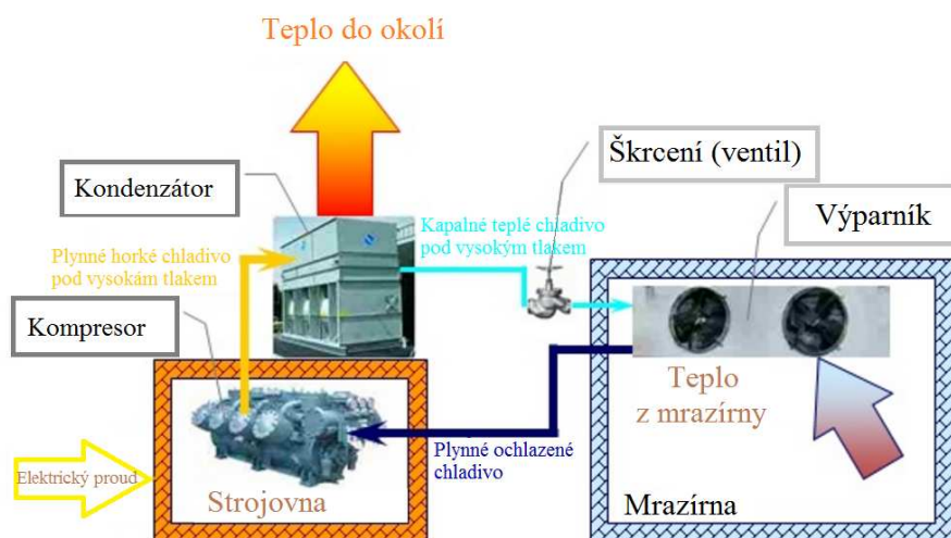
Obr. 7 Schéma jednoduchého mrazicího okruhu
