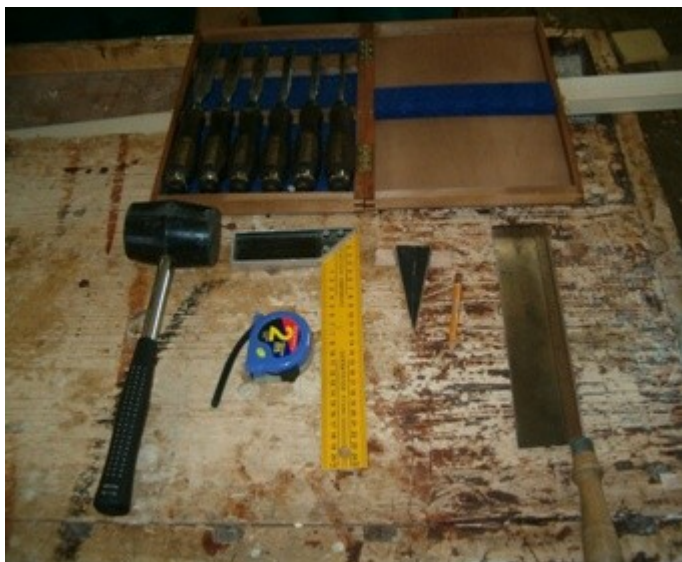
Obrázek č. 4: Vybrané ruční nástroje pro cvičnou práci v oboru truhlář - zhotovení čepového spoje (Kovář, 2011, s. 51)
