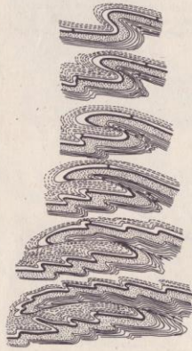
44. Schematické znázornění vývoje vřásového příkrovu.
