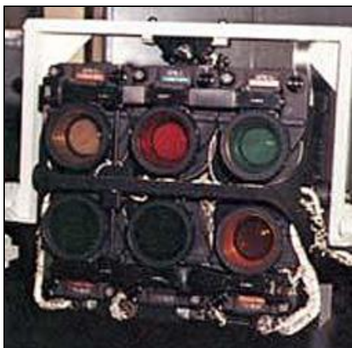
Obr. 2.13 Multispektrální kamera díky pásmovým filtrům zaznamenává současně snímky z několika pásem spektra, zdroj [7].
