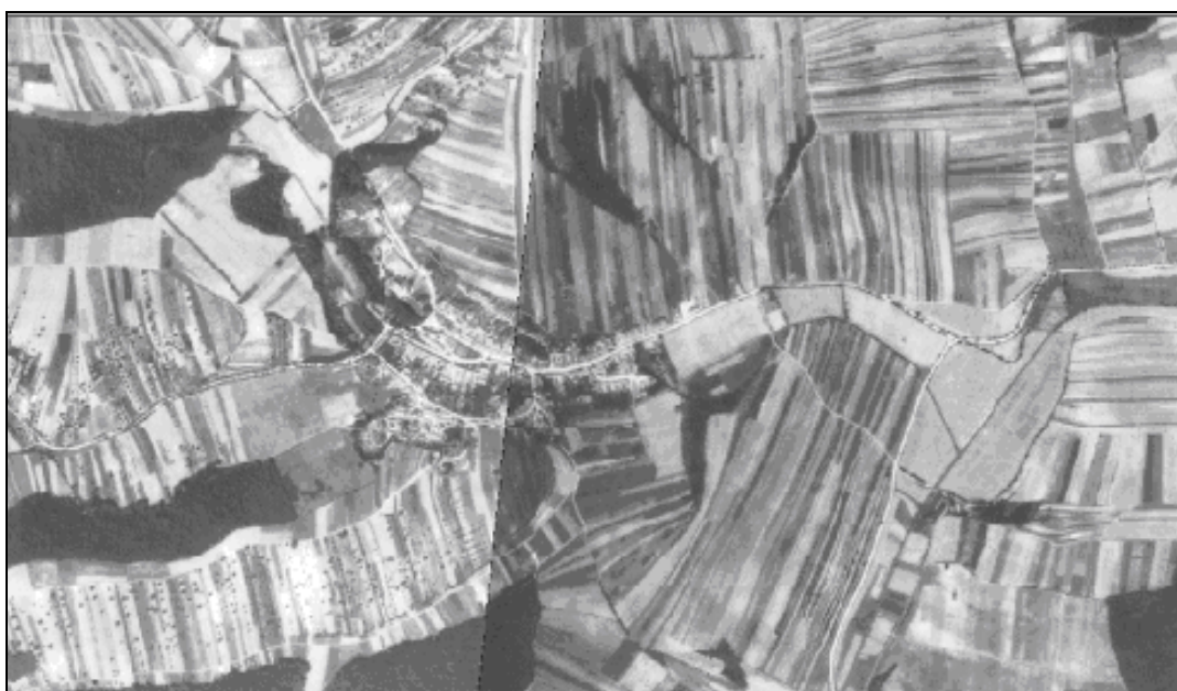
Obr.7.4 Licování (např. návaznost silnice) ortorektifikovaných snímků je velmi dobré, ale patrný velký rozdíl jasu barvy na obou snímcích
