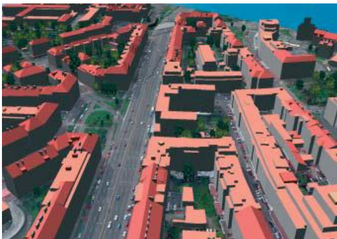
Obr. 7.1 3D modelování a vizualizace – na digitální model terénu se “položí” letecký nebo družicový snímek, do krajiny lze přidat trojrozměrné budovy, stromy apod., zdroj [7].
