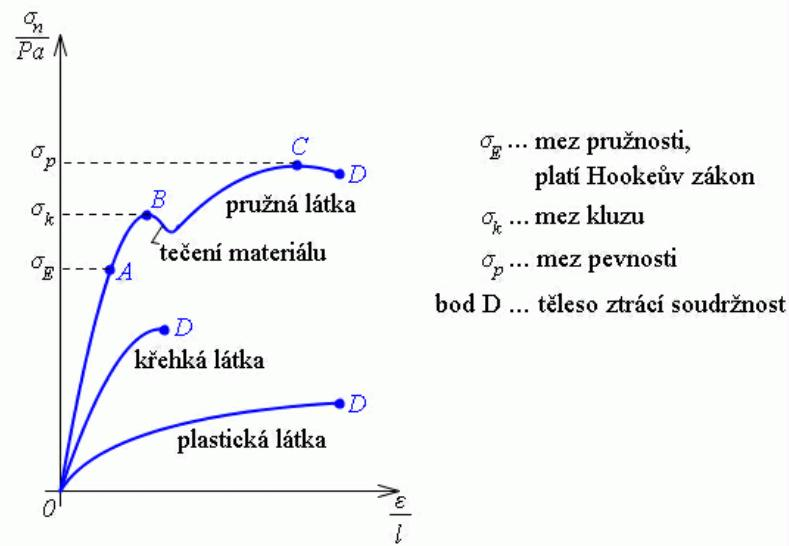
Při překročení tohoto napětí poruší se soudržnost materiálů, při tahovém namáhání dochází k **přetržení tělesa**.
