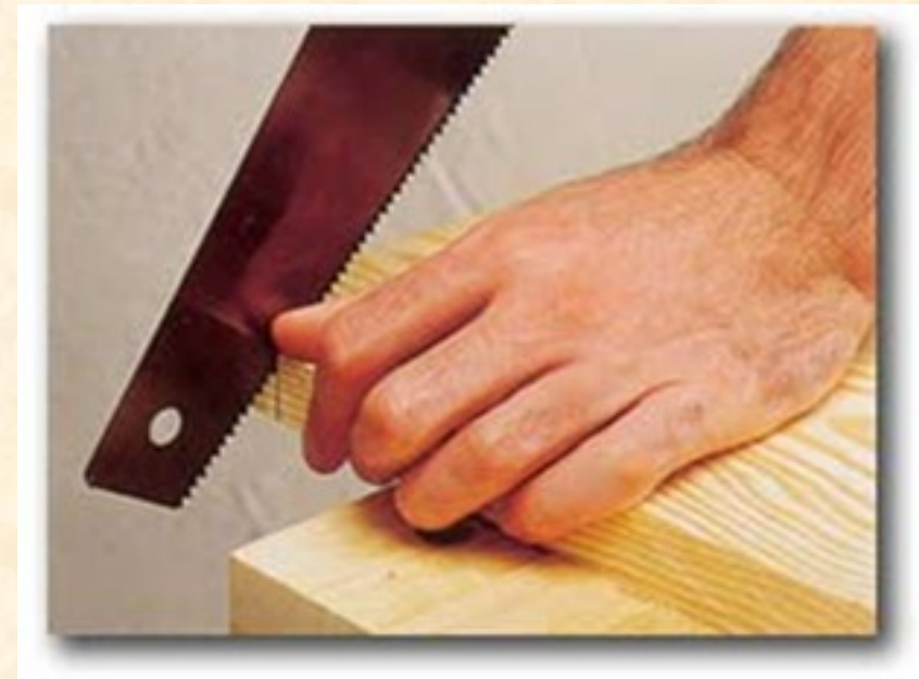
Obrázek 1. Vytvoření základního zářezu (Zdroj: Corbett, 2004)
