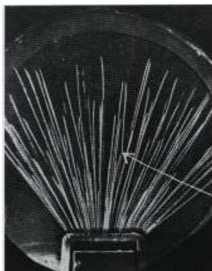
Obr.5. Wilsonova mlžná komora (částice alfa)
