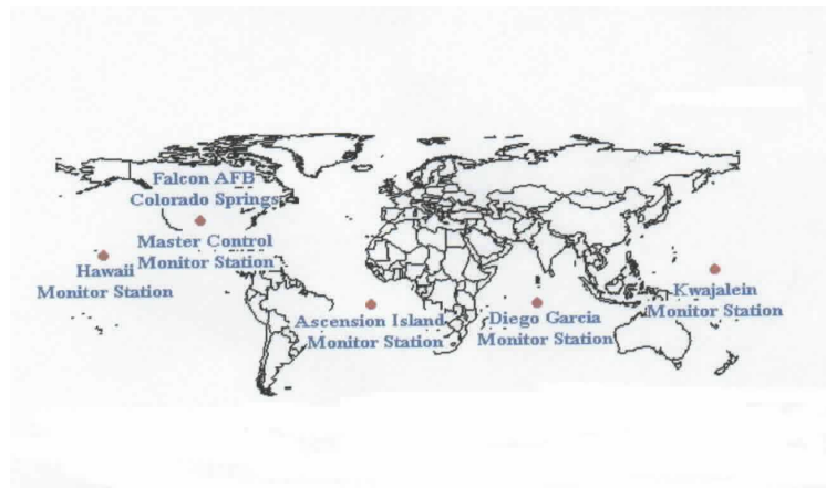
Obr. 2 Hlavní řídicí stanice GPS
