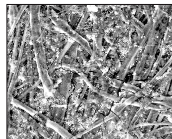
Obrázek 4-14. Povrch papíru se nám zdá hladký, ale na mikroskopické úrovni zjistíme, že tomu tak není. Snímek z elektronového mikroskopu, zvětšeno 150x.
