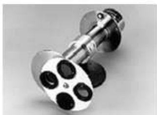
Obrázek 7: Pyrheliometr vybavený otočným kotoučem s jedním průřezem a třemi barevnými filtry – převzato z [15]
