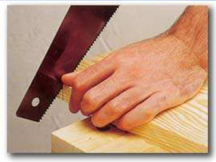
Vytvoření základního zářezu
