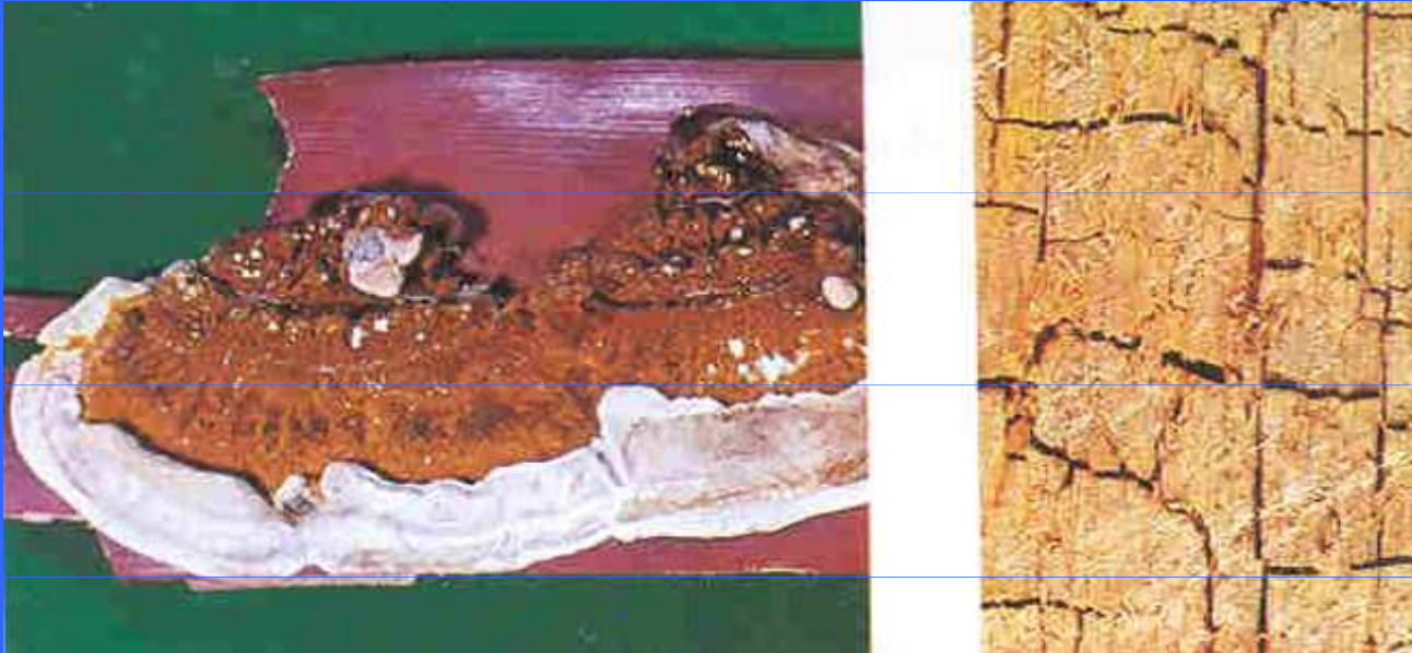
Dřevomorka domácí (vpravo jí způsobená škoda)
