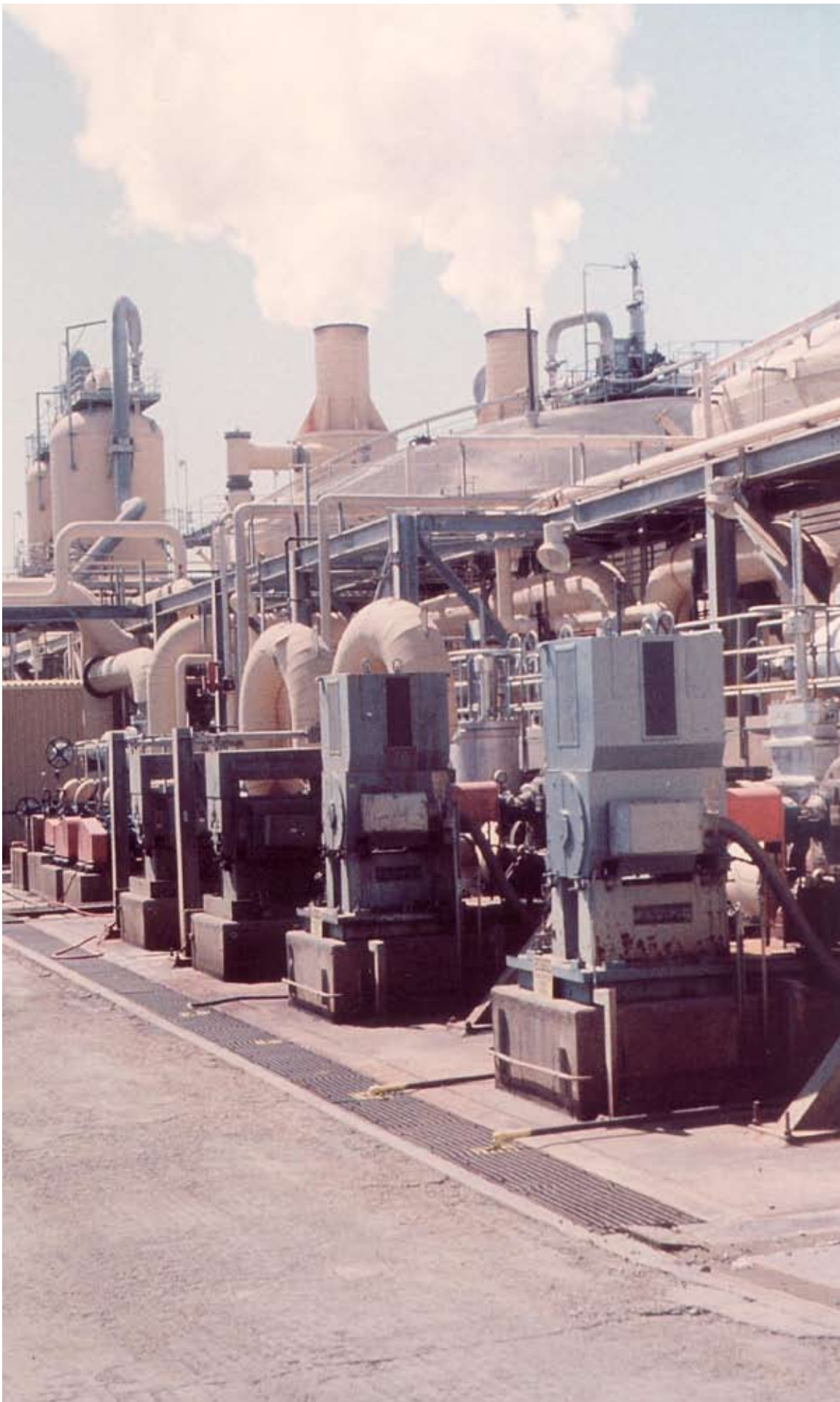
Obr. 68 Geotermální elektrárna Salton Sea v USA uvolňuje značné množství páry a v ní obsažených plynů, zejména sloučenin síry.
