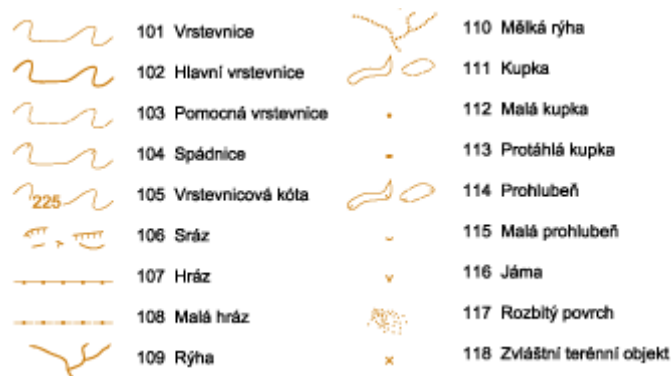
Obr. 9: Terénní tvary podle normy ISOM 2000
