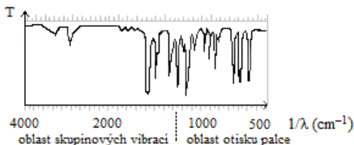
Obr. 8.10: Vibračně-rotanční spektrum \text{C}_8\text{H}_8\text{O} . Převzato z [41].
