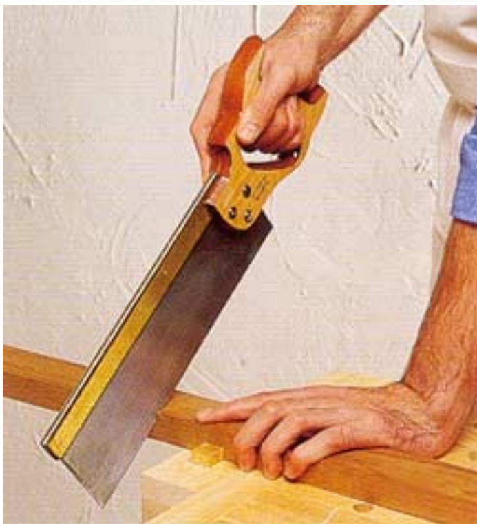
Vytvoření základního zářezu
