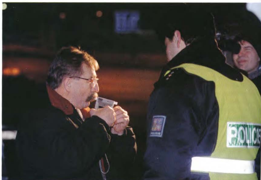
Dechový analyzátor se používá ke zjišťování, zda řidič pil alkohol. Měří množství alkoholu v dechu, který řidič vydechuje, a převádí ho na množství alkoholu v krvi.
