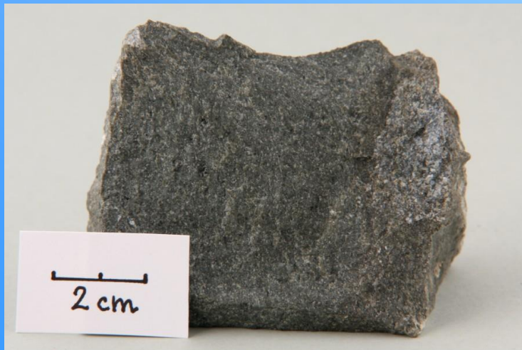
Jemně zrnitý fonolit, Pustý zámek.
