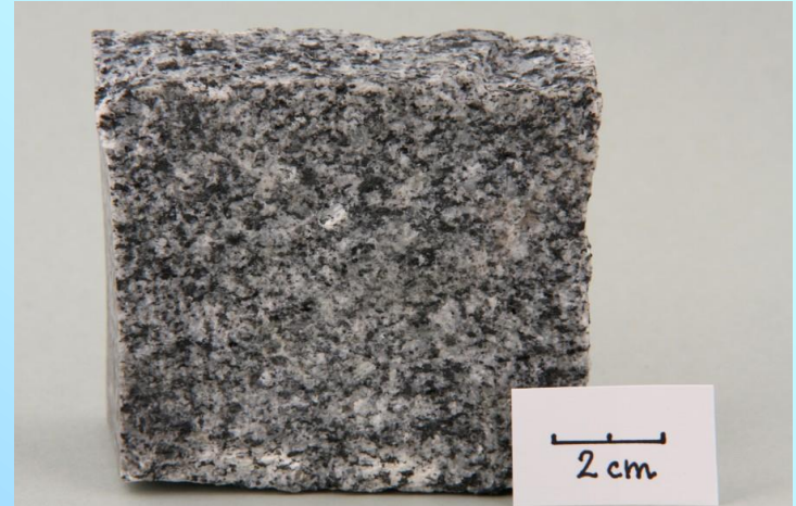
Středně zrnitý granodiorit, železnohorský pluton, Prosetín.
