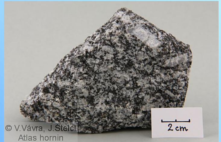
Porfyrický syenit s vyrostlicemi k-živců, třebíčský pluton, Kamenná.
