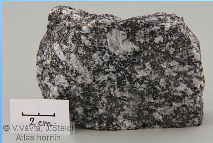
Hrubě zrnitý syenit s porfyrickou stavbou, vyrostlice tvoří K-živec, Vepice.
