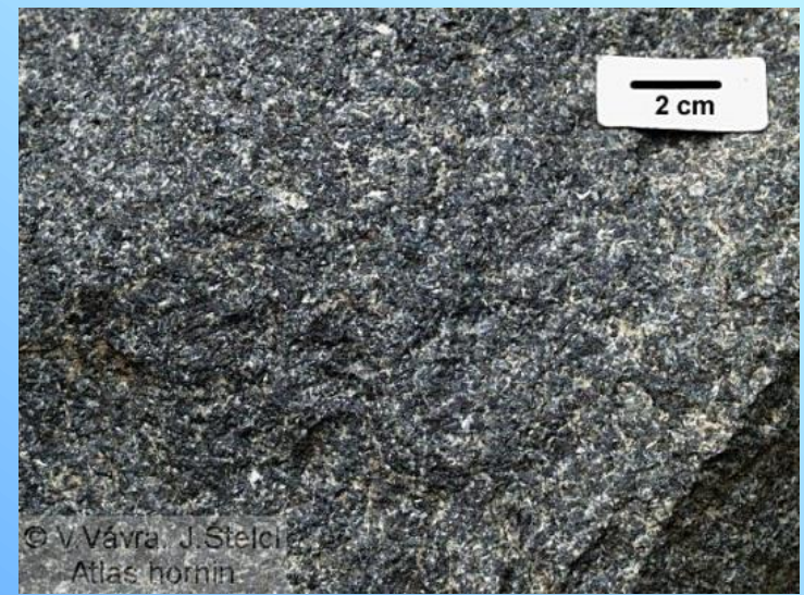
Drobně zrnitý diorit, lužický pluton, Rožany.
