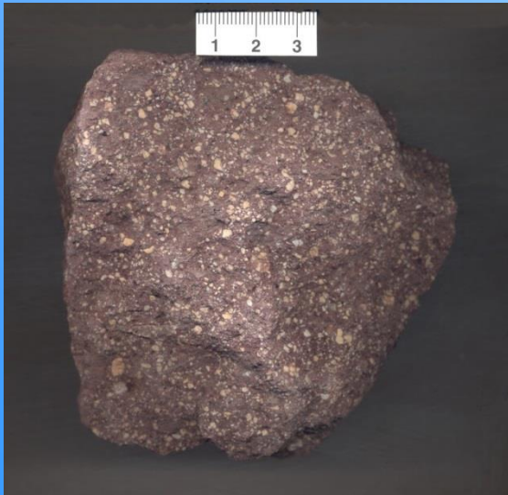
Porfyrická stavba červeného ryolitu, vnitrosudetská pánev, Ruprechtice.
