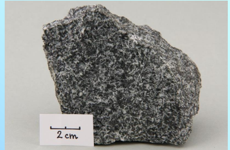
Bílé lištvité plagioklasy ve středně zrnitém dioritu, lužický pluton, Rožany.
