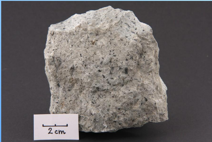
Světlý fonolit s vyrostlicemi tmavých minerálů, Mojžíř.
