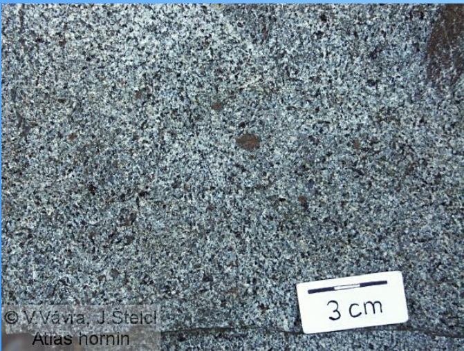
Středně zrnitý syenit se sloupečky amfibolů, jihlavský masiv, Kosov.
