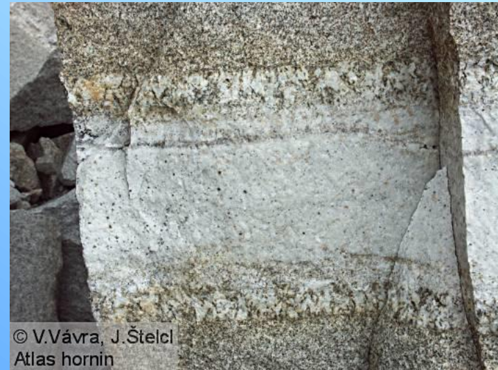
Aplitová žíla s hrubozrnným okrajem v granitu, žulovský pluton, Černá Voda.
