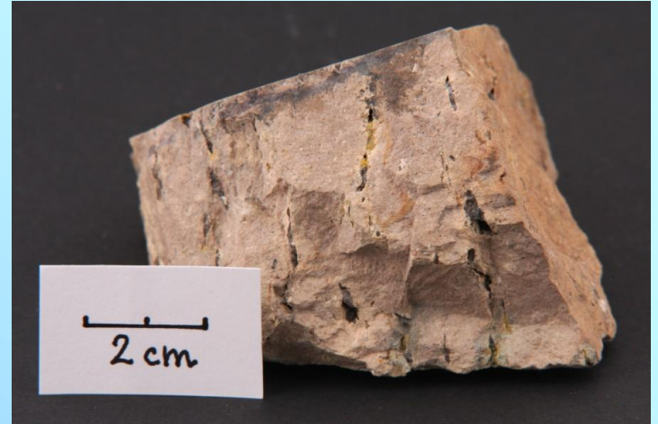
Pórovitá stavba růžového ryolitu, Královec u Žacléře.
