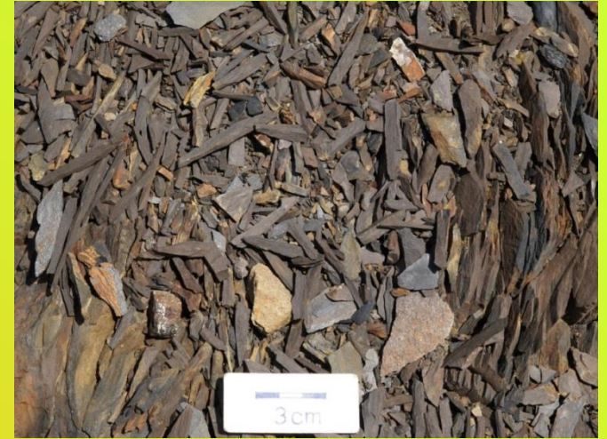
Typický střípkovitý rozpad jílových břidlic při zvětrávání, Stará Ves.
