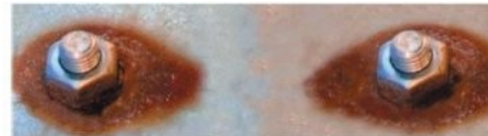
Obr. 1 Příklad bimetalické koroze šroubů z korozivzdorné oceli použitých pro spojení žárově zinkovaných dílů
