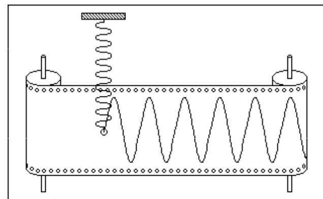
Mechanický oscilátor je tvořen pružinou, na níž je zavěšena miska se závažím. Perioda oscilátoru je 0,5 s. Přidáním dalšího závaží se perioda oscilátoru zvětší na 0,60 s. Určete o kolik cm se pružina přidáním závaží prodloužila.
