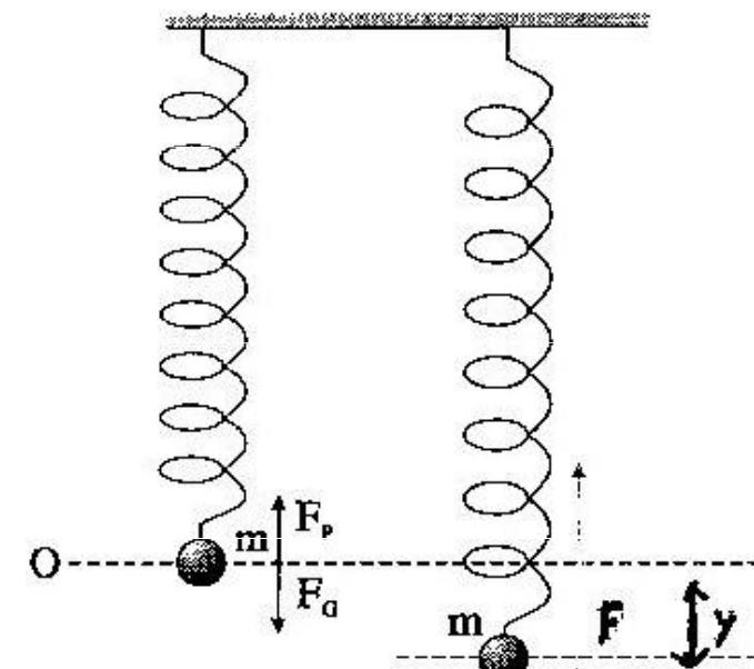
Mechanický oscilátor tvořený tělesem o hmotnosti 5 kg vykoná 45 kmitů za minutu. Určete tuhost pružiny.
