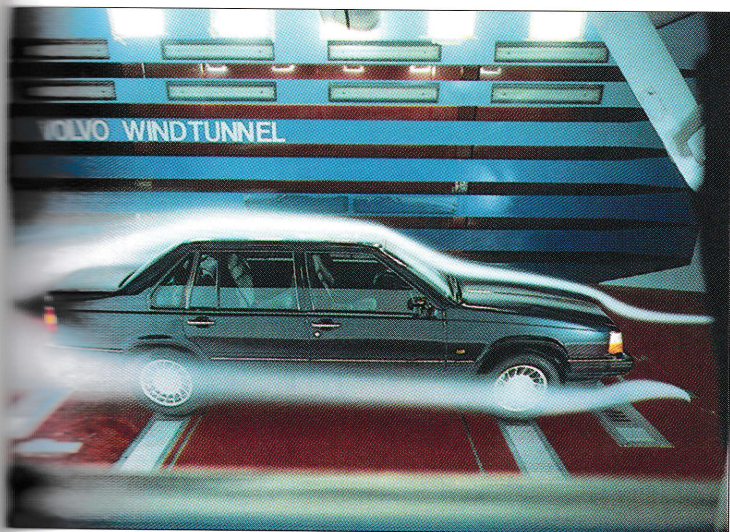
Obr. 15.14 Kouřem zviditelněné proudnice, které obtékají automobil umístěný v aerodynamickém tunelu.
