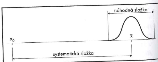
Obr. 3.2. Schematické znázornění vlivu chyb na přesnost a pravdivost laboratorního výsledku ( x_0 = skutečná hodnota, \bar{x} = průměr výsledků opakovaných měření)
