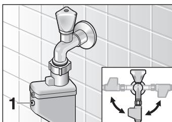
Připojte přívodní hadici k přívodu vody.
