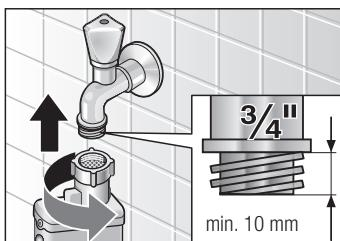
Plastický závit smí být utáhnutý pouze rukou. Neodstraňujte filtr z přívodní hadice.
