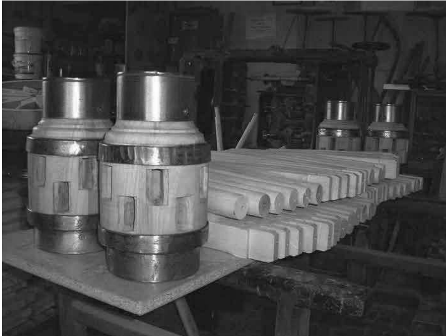
obr. 1 kolářské polotovary - náboje s kováním a špice
