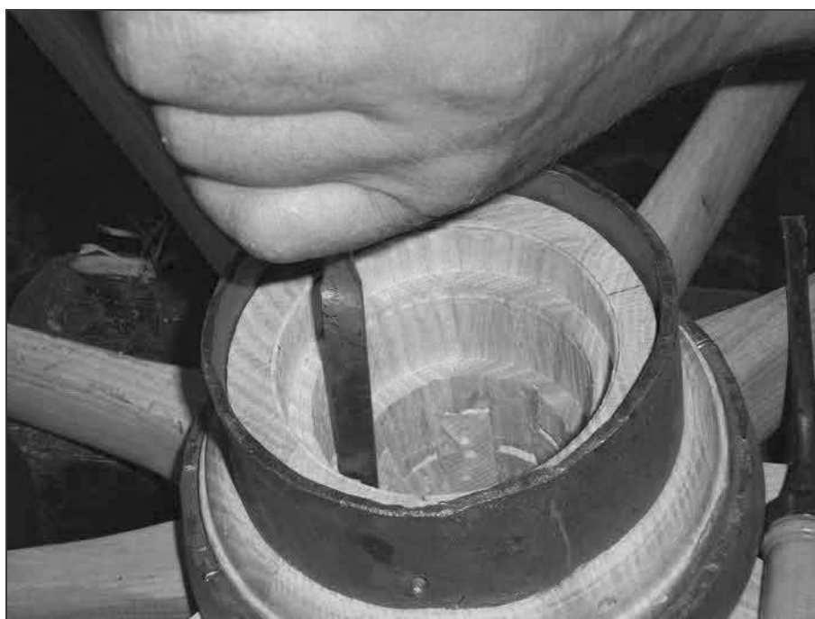
obr. 6 hranění čepů kolářským dlátem - děropáčem
