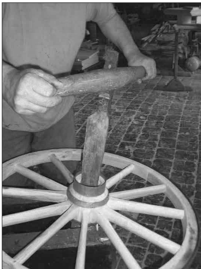
obr. 5 vrtání otvoru pro čep nápravy – kolářským vrtákem bukšákem
