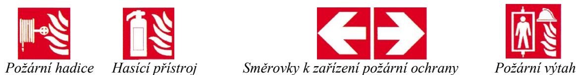
Obr. P5.5 Informativní značky pro věcné prostředky požární ochrany, požárně bezpečnostní zařízení a směr cesty
