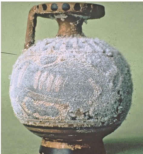
Solný výkvět na keramice při nízké RV
