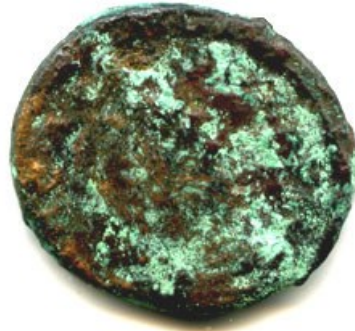
Aktivní koroze slitin mědi – nemoc bronzů
