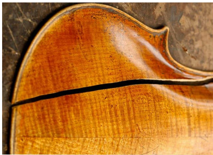
Praskání dřeva při nízké RV
