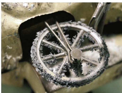
Poškození vlivem kyseliny mravenčí (vlevo) a octové (vpravo)
