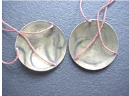
Černání stříbra po kontaktu s vlněným provázkem
