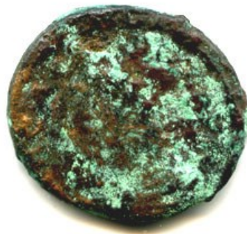
Aktivní koroze slitin mědi – nemoc bronzů
