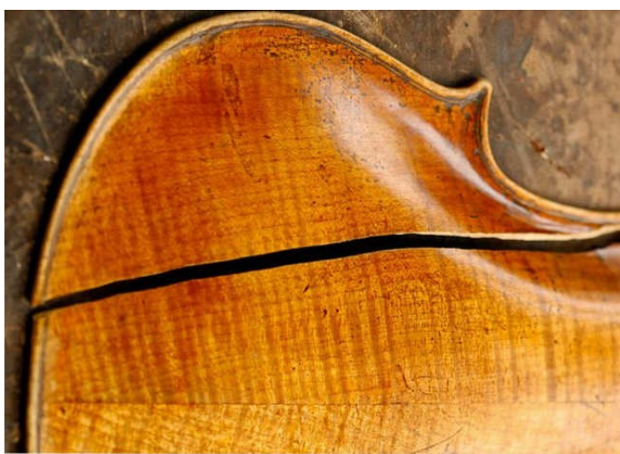
Praskání dřeva při nízké RV
