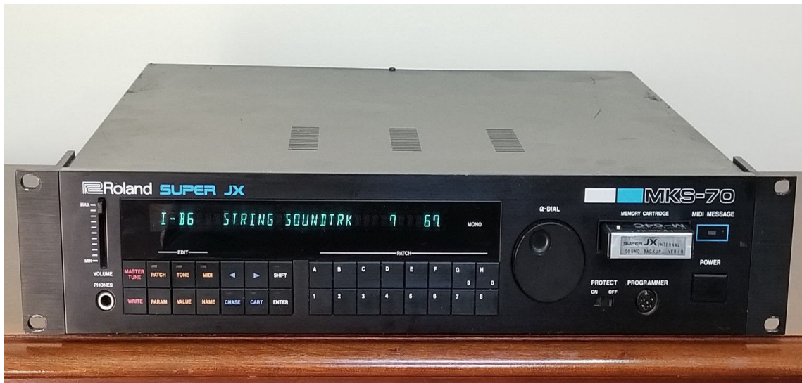
obr., hybridní zvukový modul Roland Super JX – MKS 70 vybavený MIDI, zdroj: https://www.matrixsynth.com/2018/12/roland-mks-70-synth-module-of-super-jx.html
