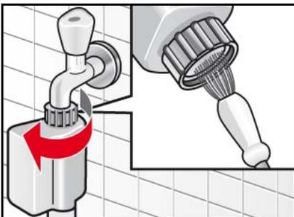
Wenn kein oder nicht genügend Wasser in den Wäschetrockner einläuft, zunächst Wasserdruck im Zulaufschlauch abbauen:
