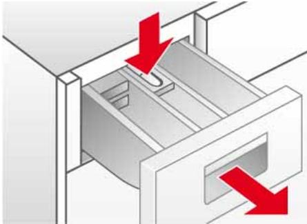
Die Waschmittelschublade ist in drei Kammern unterteilt
