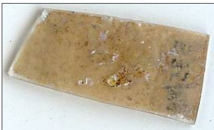
5 | 6 Obr. 5. Vznik \text{SiO}_2 gelové vrstvy difúzí alkálií (Foto. R. Kozáková)
