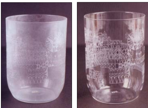
Obr. 14 Vrstva rozpustných alkalických solí ( \text{NaHCO}_3 aj., někdy až mazlavého \text{NaOH} . Stačí umýt vodou)
