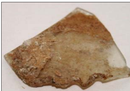
Obr. 16 Vznik HAp byl potvrzen RTG difrakcí (OM – Foto V. Šimková)
