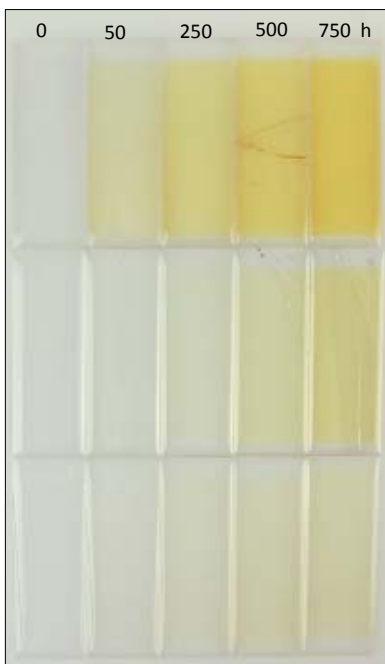
Obr. 4 Snímek vzorků stárnutých UV zářením horní řada: Araldite 2020 střední řada: Epo-Tek 301-2 dolní řada: Hxtal NYL-1
