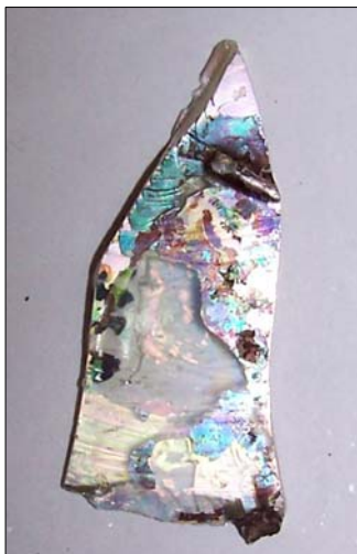
5 | 6 Obr. 5. Vznik \text{SiO}_2 gelové vrstvy difúzí alkálií (Foto. R. Kozáková)
