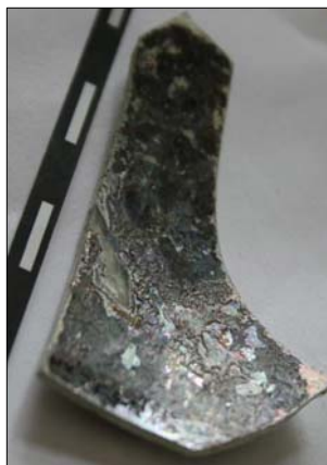
Obr. 20 Typická iridiscentní vrstva s obsahem Fe (Foto. V. Šimková)
