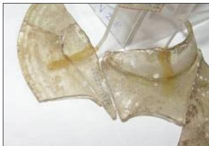
1 | 2 Obr. 1 Ukázka části dřívě restaurovaného předmětu; patrná změna optických vlastností polymeru
