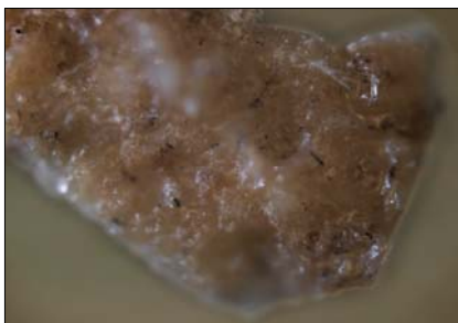
Obr. 15 Po umytí vodou je vrstva alkalického precipitátu odstraněna (Foto: Koob S.P. Conservation and care of glass objects, 2006)
