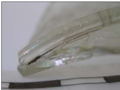
3 | 4 Obr. 3 Zkoušky čištění laserem, sklo před čištěním (Foto. V. Šimková) Obr. 4 Po čištění špatně dostupného místa, přístrojem Artlight II., MVČ Hradec Králové (Foto. V. Šimková)
