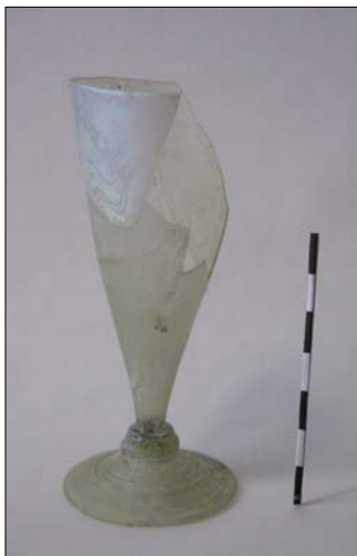
Obr. 8 Odlupující se vrstvy SiO 2 z významně zkorodovaného povrchu skla (OM - Foto: L. Klikarová)
