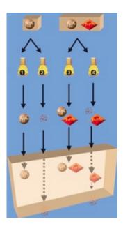
BSE-Schnelltest: Die verflüssigte Gewebeprobe wird einer Protease-Behandlung unterzogen, bei der PrP(C) zerstört wird (Kolben 2 und 4, Kolben 1 und 3 sind unbehandelt). Das verdauungsresistente Prionprotein PrP(sc) wird nun in einem Immunoblotting-Verfahren nachgewiesen.
