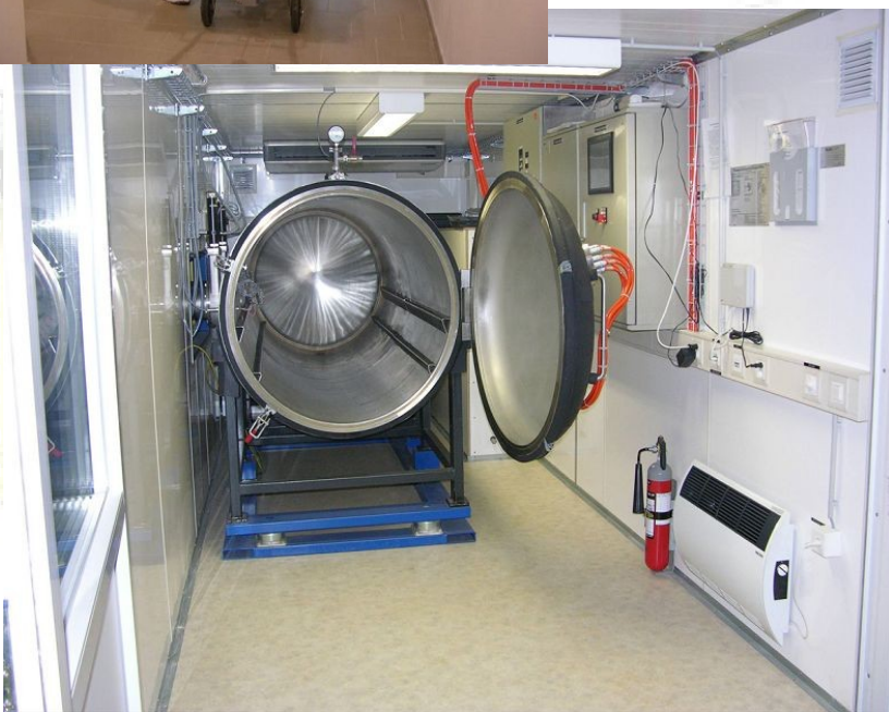
Mobilní lyofilizační komora – objem 2 m 3 (vnitřní podmínky: vakuum, teplota pod -40 °C)
