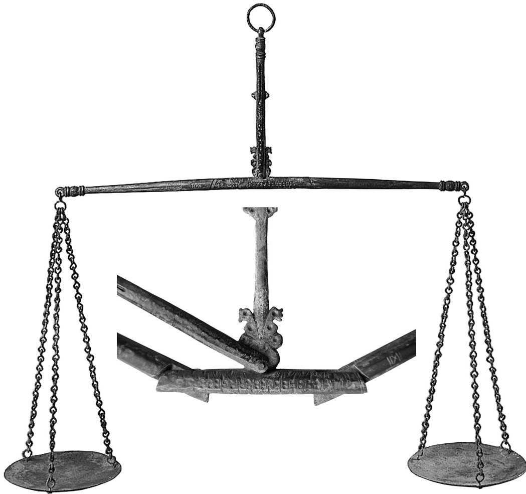
Abb. 5b Sonderform einer Klappwaage. Privatsammlung München C. S. Inv.-Nr. 1358. Ähnlich dem Typ 8 (Dr. Christian Schmidt).
