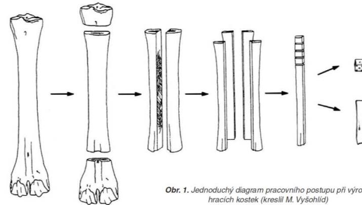
Obr. 1. Jednoduchý diagram pracovního postupu při výrobě hracích kostek (kreslil M. Vyšohlíd)
