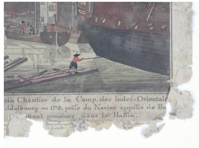
Hydrolytický rozklad papíru, zkřehnutí
